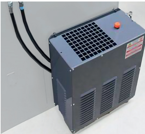
Circuit de refroidissement broche
